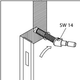
3. Unterlegscheibe auf Spezialschraube M10 aufstecken. Spezialschraube festdrehen und ausrichten.
