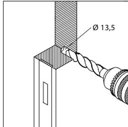
1. Von der Griffseite mit 13,5 mm Bohrer bohren.
