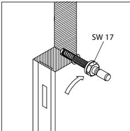
3. Unterlegscheibe auf Spezialschraube M10 aufstecken. Spezialschraube festdrehen.
