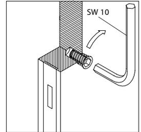
2. Rampamuffe mit Inbusschlüssel eindrehen.
