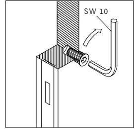
2. Rampamuffe mit Inbusschlüssel eindrehen.
